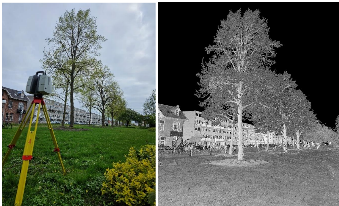
Foto 1. De 3D scanner en het scanresultaat op locatie in gemeente Groningen.
