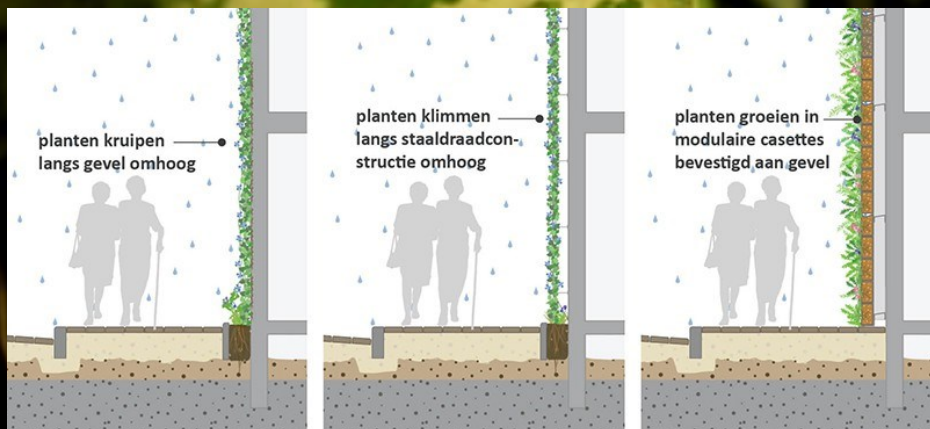
Schematische doorsneden van drie verschillende groene gevel systemen
